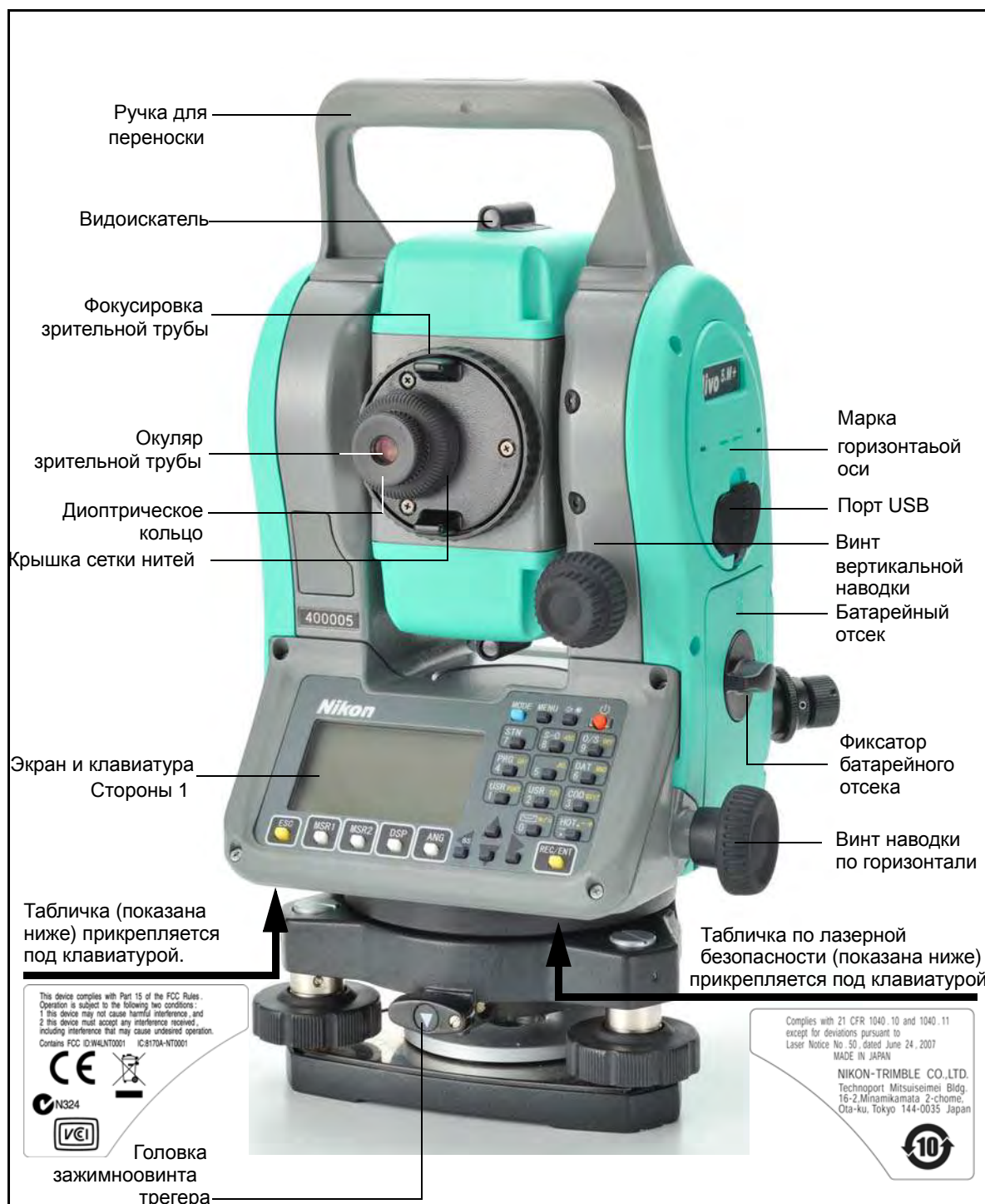
Рисунок 1.1 Электронный безотражательный тахеометр серии Nivo – Сторона-1
