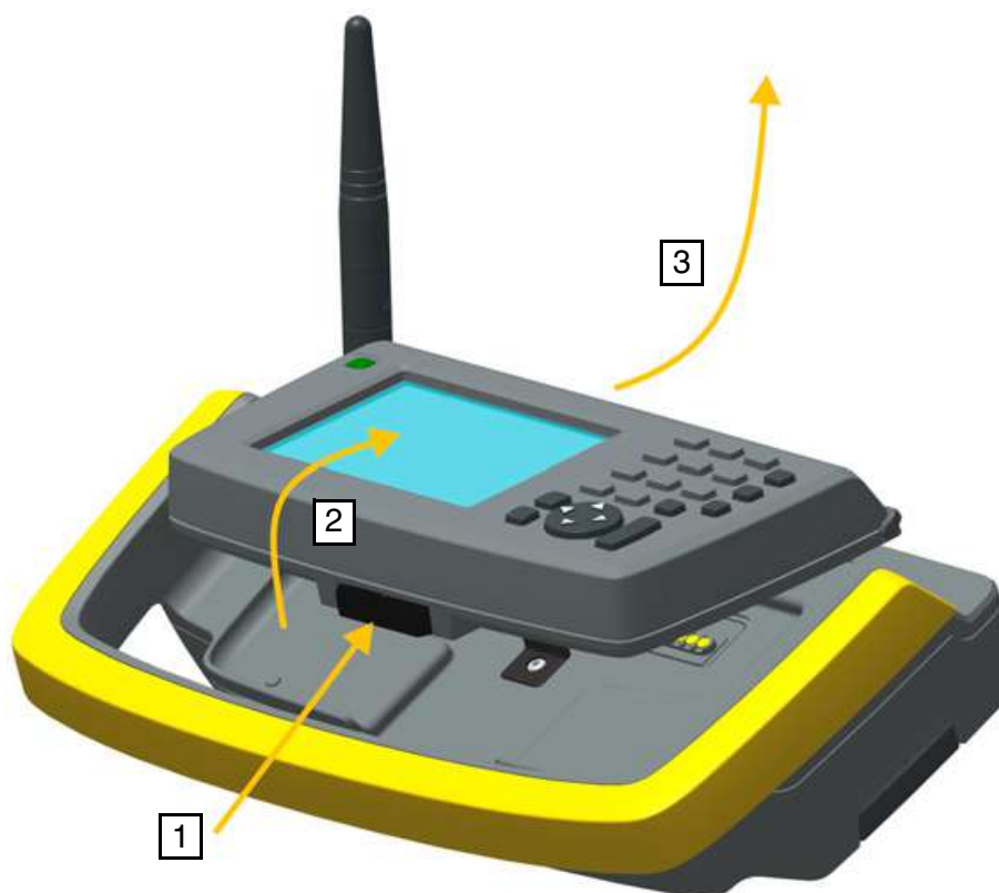
Рисунок 6.22. Снятие контроллера Trimble CU с держателя Trimble Robotic
