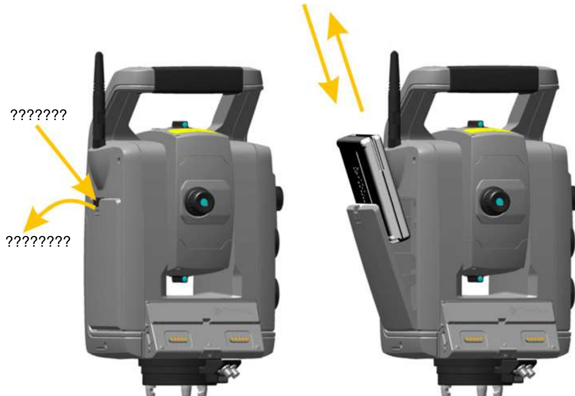
Рисунок 3.7. Установка и извлечение внутренней батареи
