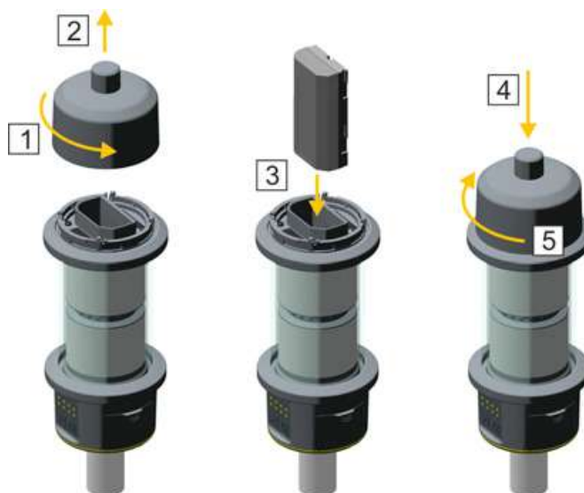
Рисунок 6.15. Установка батареи в отражатель Trimble Active Track 360
