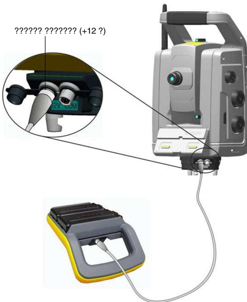
Рисунок 6.2. Подключение адаптера для нескольких батарей
