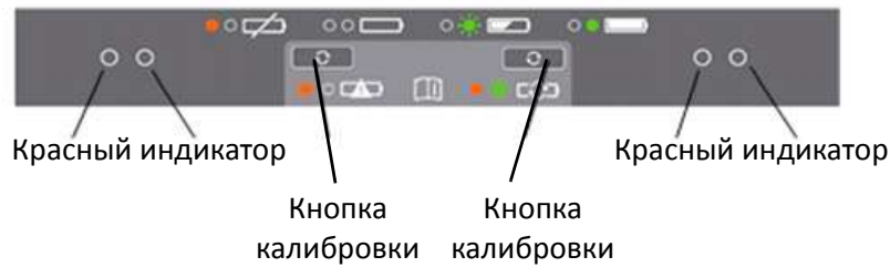
Рисунок 3.6. Панель управления зарядного устройства на две батареи
