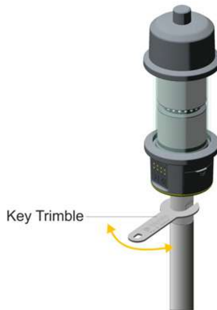
Рисунок 6.17. Установка и снятие отражателя Trimble Active Track 360
