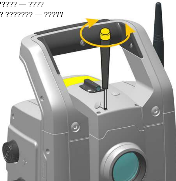
Рисунок 4.6. Юстировка положения лазерного указателя по вертикали
