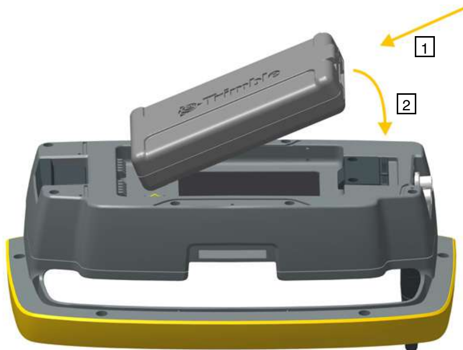
Рисунок 6.19. Установка батареи в держатель Trimble Robotic
