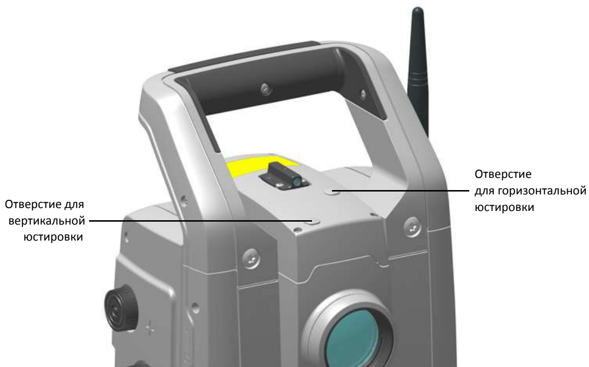
Рисунок 4.5. Отверстия юстировочных винтов лазерного указателя
