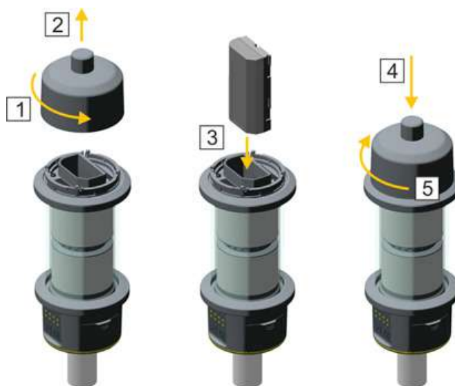
Рисунок 6.15. Установка батареи в отражатель Trimble Active Track 360
