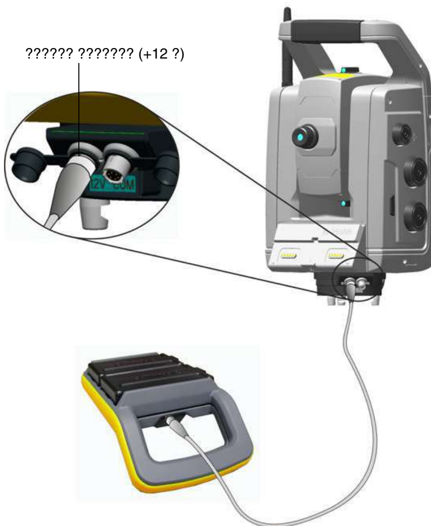
Рисунок 6.2. Подключение адаптера для нескольких батарей
