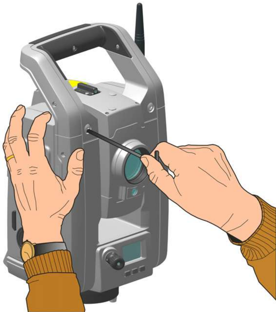
Рисунок 3.13. Отсоединение ручки инструмента
