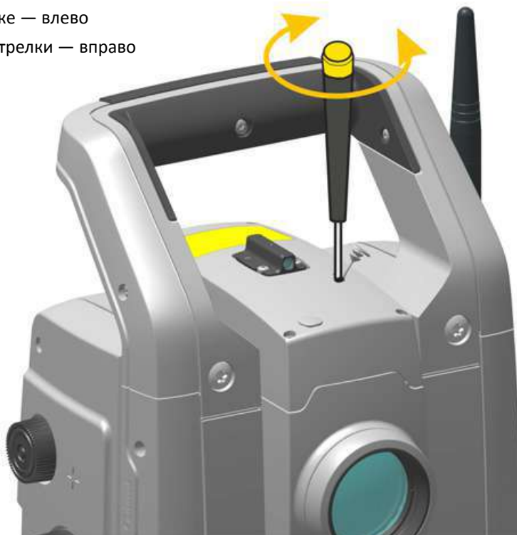
Рисунок 4.7. Юстировка положения лазерного указателя по горизонтали
