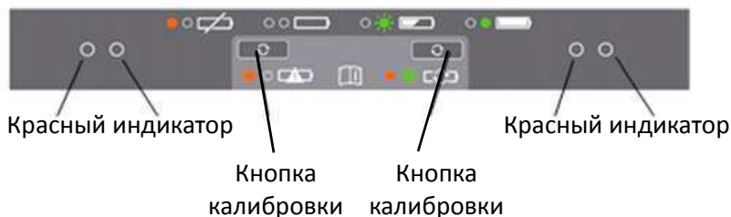
Рисунок 3.6. Панель управления зарядного устройства на две батареи
