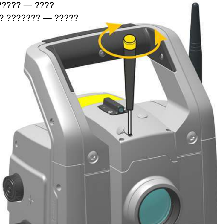
Рисунок 4.6. Юстировка положения лазерного указателя по вертикали
