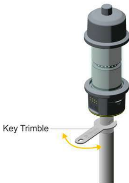
Рисунок 6.17. Установка и снятие отражателя Trimble Active Track 360
