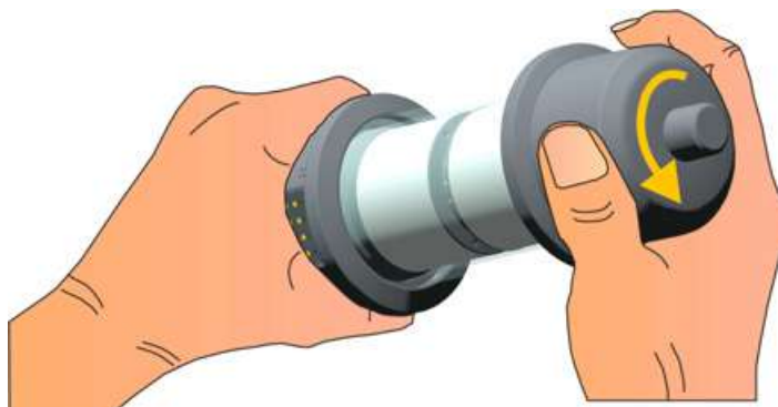
Рисунок 6.14. Так следует держать отражатель, открывая крышку батарейного отсека
