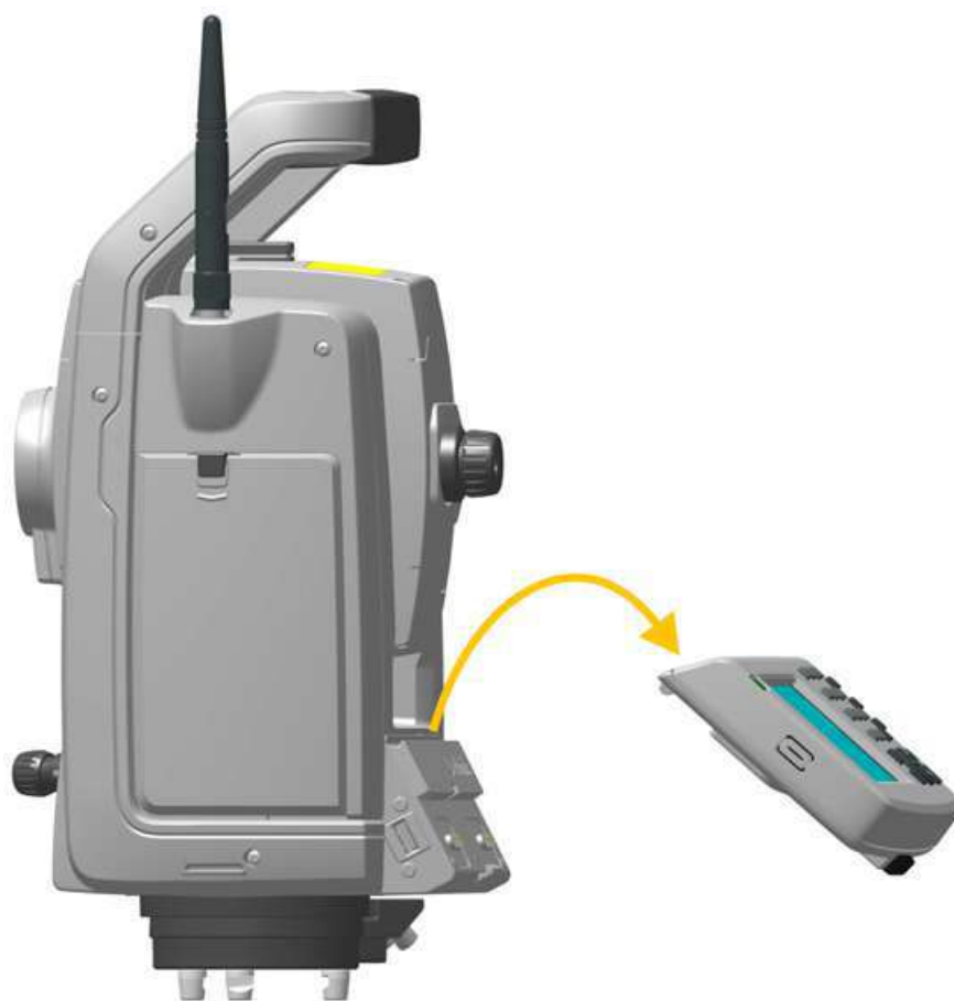
Рисунок 4.15. Снятие TCU с инструмента
