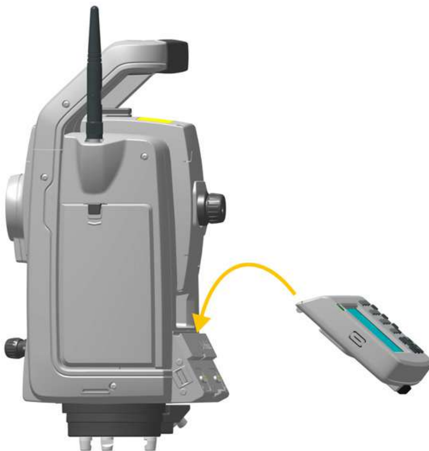
Рисунок 4.12. Установка TCU на инструмент
