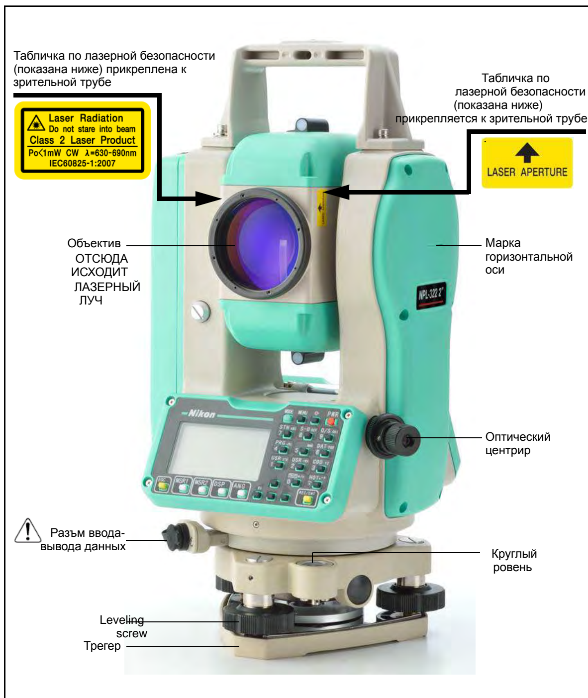
Рисунок 1.2 Электронный тахеометр NPL-322+ (модель с точностью 2")
