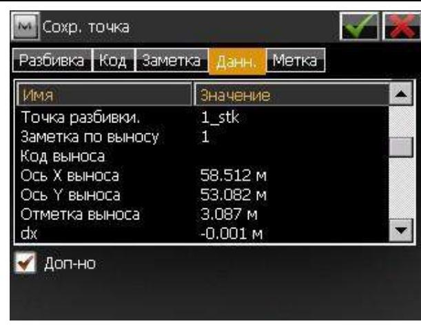
В появившемся окне отображается вся информация о вынесенной точке. Для подтверждения сохранения нажимаем на . Прибор автоматически повернется на следующую проектную точку.
