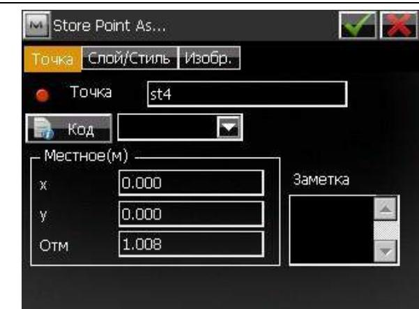
Появится окно с координатами текущей точки стояния прибора с перевычисленной высотой прибора относительно исходной реперной высоты. Нажимаем на .
