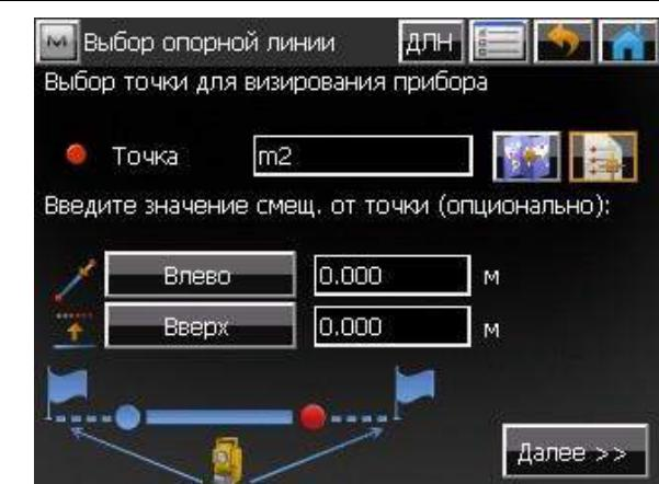
**Шаг 2.** После измерения, программное обеспечение предлагает выбрать вторую точку опорной линии. Выбираем вторую точку и нажимаем “Далее >>”.
