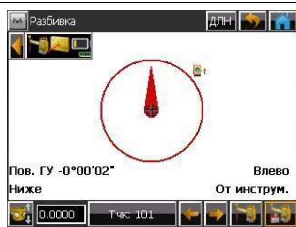
Нажимаем на иконку
