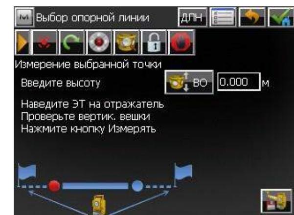
В поле **ВО** **[0.000 м]** водится высота отражателя (если требуется). Наводимся на первую точку и нажимаем на .
