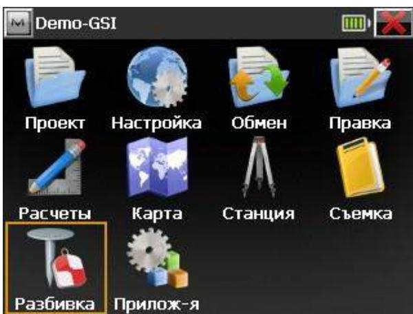
В основном меню ПО MAGNET Field нажимаем пальцем или стилусом на иконку “Разбивка”.
