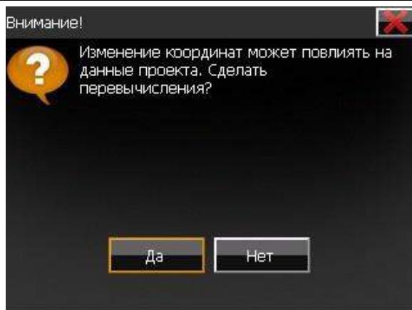
Появится окно с вопросом – “Сделать перевычисления?” нажимаем “Да”. Так как высота прибора была вычислена заново и если с данной точки стояния были сделаны ранее измерения, то высота их будет перевычислена.
