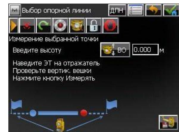
В поле **ВО** **[0.000 м]** водится высота отражателя (если требуется). Наводимся на вторую точку и нажимаем на .
