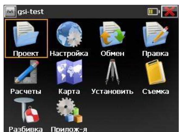
Для начала работ необходимо создать проект или выбрать его из списка, если вы его ранее создавали и хотите продолжить в нём работу. В основном меню ПО MAGNET Field выбираем “Проект” (Рис.4). Нажимаем “Создать” (Рис.5). В поле **Имя**  вводится имя текущего проекта. (Рис.6). Остальные поля заполняются на ваше усмотрение. Нажимаем “Далее >>”.
