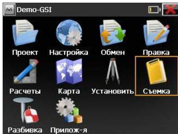
В основном меню ПО MAGNET Field нажимаем пальцем или стилусом на иконку “Съемка”.
