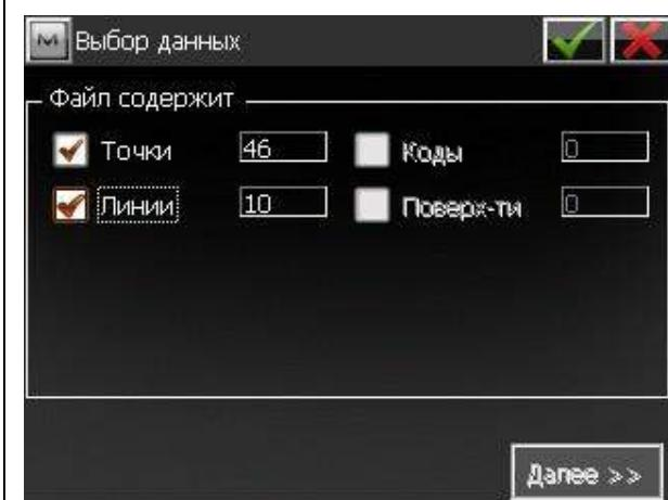
Файл содержит “46 точек” и “10 линий” ставим напротив галки и нажимаем на .
