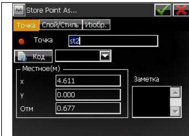
Так как в предыдущем меню была поставлена галка на  Иzm. расст., программа вычислила координаты точки ОРП относительно координат текущей точки стояния прибора. Задаём имя точки ОРП (например: st2) и нажимаем .
