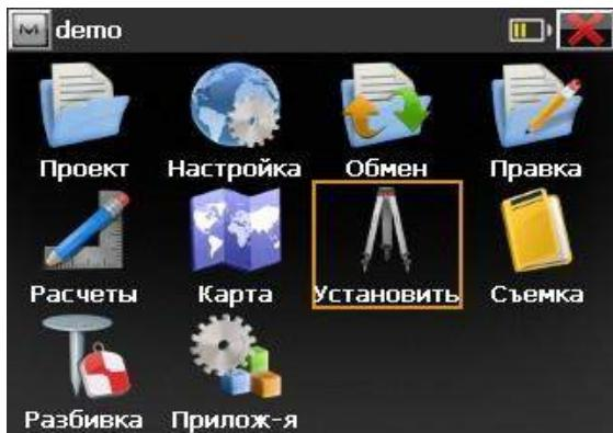
В основном меню MAGNET Field нажимаем стилусом или пальцем на иконку “Станция (Установить)”.
