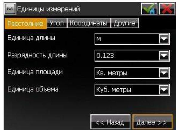
В окне “Единицы измерений” имеется возможность задать различные единицы измерения и их разрядность, чтобы MAGNET Field отображала различные числовые значения (Рис.8). По завершению настроек, нажимаем “Далее >>”.
