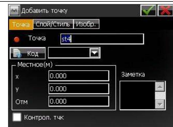
В меню “Добавить точку” вбиваем координаты текущей станции. Так же мы можем задать имя станции, присвоить код, слой, изображение и т.д. По завершении настроек нажимаем на зелёную галку .
