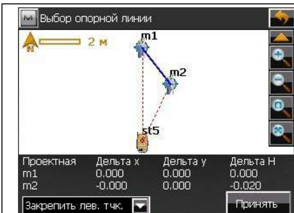
После второго измерения появится окно со схемой точки стояния прибора относительно опорной линии и точностью определения координат точки стояния прибора относительно координат базовой линии. Если точность определения координат станции вас устраивает, нажимаем **Принять**.
