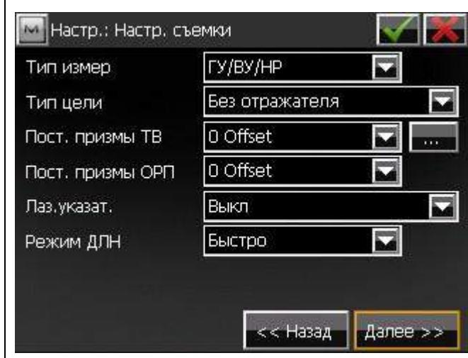
В списке “Тип измерения” выбирается порядок и тип измерений в одном приеме, где ГУ – горизонтальный угол, ВУ – вертикальный угол, НР – наклонное расстояние, ГП – горизонтальное проложение, Прев – превышение.
