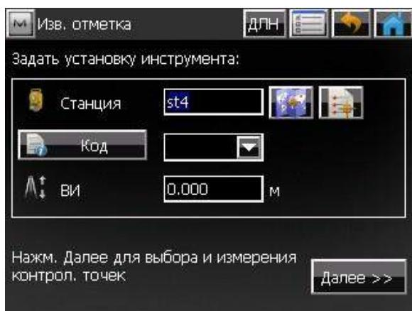
В данном меню вводится имя станции, высота которой будет определена после измерений (например: st4) и нажимаем “Далее >>”.
