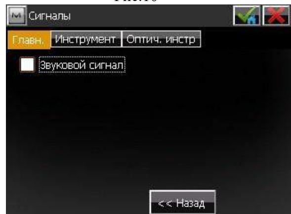
В окне “Показывать” имеется возможность сконфигурировать отображение настроек (Рис.9). Нажимаем “Далее >>” В окне “Сигналы” имеется возможность отключения или включения звуковых оповещений (Рис.10). По завершению настроек, нажимаем на Вы только что создали новый проект!
