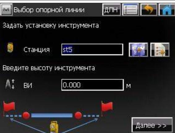
В данном меню вводится имя станции, координаты которой будут определены после измерений (например: st5), если требуется ввести высоту инструмента, то вводим её в ячейку  м и нажимаем “Далее >>”.
