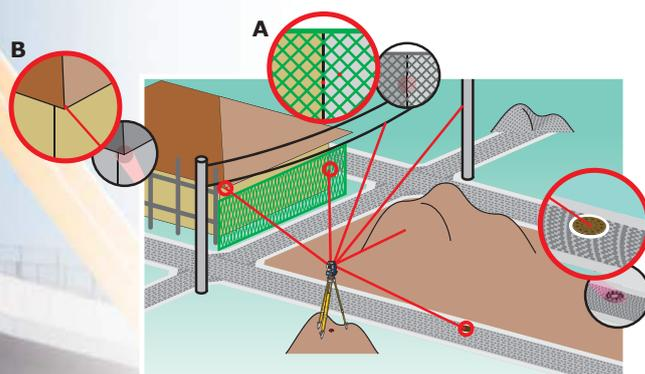
Тончайший луч дальномера позволяет с высокой точностью выполнять измерения на стены и углы зданий, люки колодцев, сетчатые ограждения и ветки деревьев.
