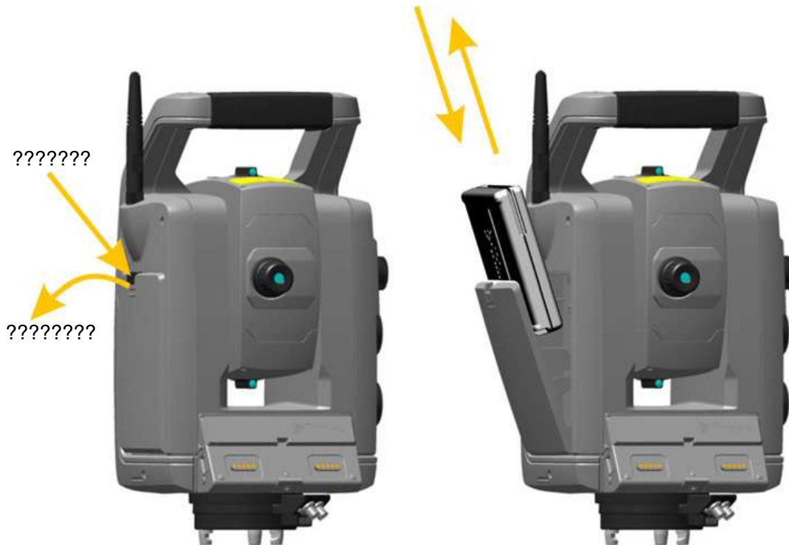
Рисунок 3.7. Установка и извлечение внутренней батареи
