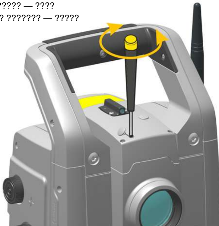
Рисунок 4.6. Юстировка положения лазерного указателя по вертикали
