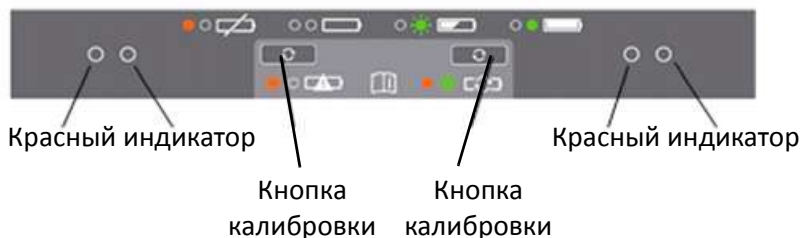
Рисунок 3.6. Панель управления зарядного устройства на две батареи
