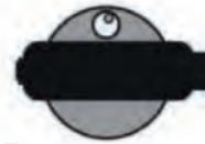
Скомпенсируйте половину смещения пузырька с помощью подъемных винтов (рис. 8). Устраните оставшуюся половину смещения вращением юстировочных винтов круглого уровня с помощью шестигранного ключа (рис. 9).
