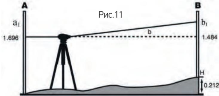
Снимите защитный кожух юстировочных винтов сетки нитей и с помощью юстировочной шпильки вращайте юстировочный винт до тех пор, пока горизонтальная нить сетки нитей не совпадет с отсчетом 1.484 м.
