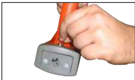
а) Выдвинуть фиксатор и освободить батарейный отсек
