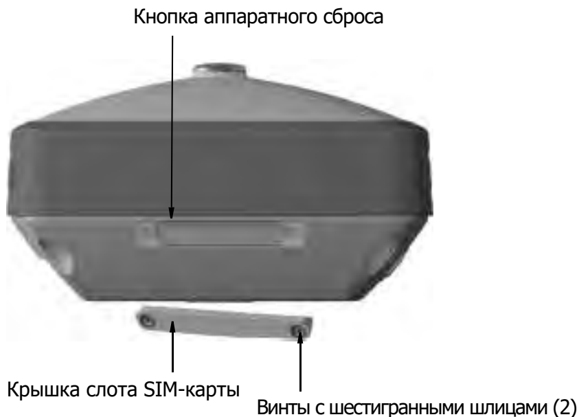
Рисунок 2-4: Удаление крышки слота SIM-карты
