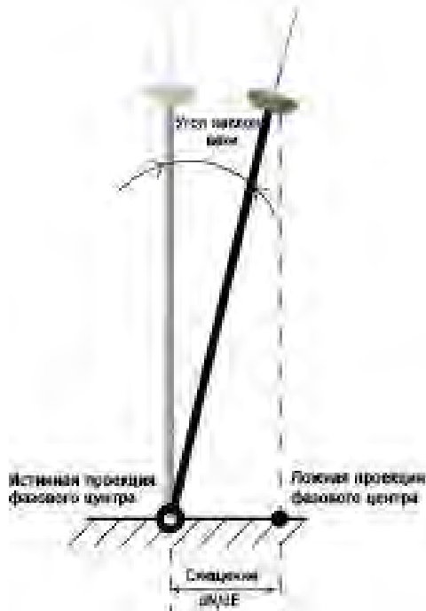
Рисунок 5-12: Режим коррекции наклона Tilt
