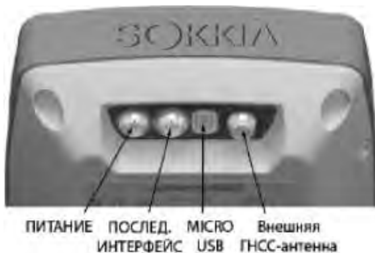
Рисунок 2-11: Низ корпуса приемника—Разъемы
