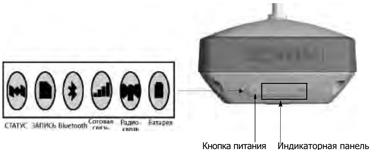
Рисунок 2-3: Нижняя часть приемника—Индикаторная панель
