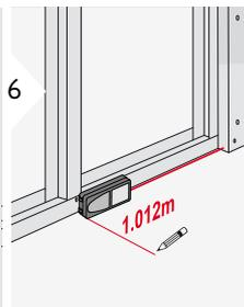
Медленно перемещайте прибор вдоль линии разметки. На дисплее отобразится расстояние до следующей разметки.
