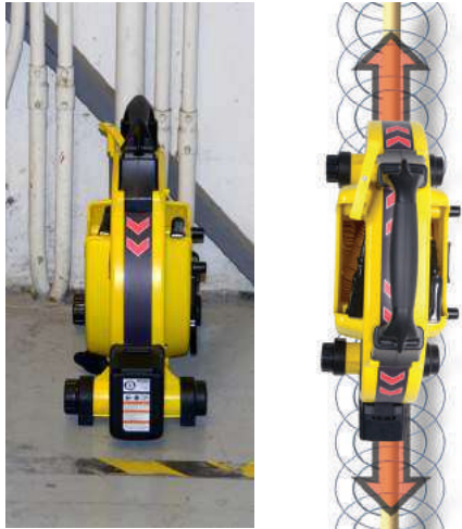
Рисунок 4 – Индукция с помощью RIDGID SeekTech ST-33Q+
