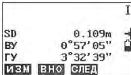
5. Нажмите F2: [ВНЮ], чтобы начать измерение недоступной высоты с разбивкой. Передвигайте зрительную трубу, чтобы найти точку разбивки.
