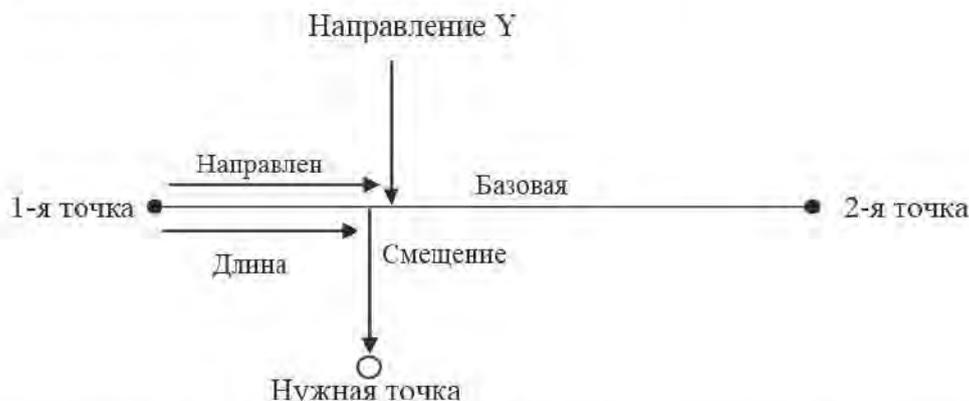
Длина — расстояние по базовой линии от 1-й точки до положения, в котором линия, идущая из нужной точки, пересекает базовую линию под прямым углом (направление X). Смещение — расстояние от нужной точки до положения, в котором линия, идущая от нужной точки, пересекает базовую линию под прямым углом (направление Y).
