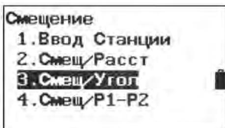
2. Наведите прибор на смещенную точку, нажмите F1: [ИЗМ] на стр. 1 в режиме измерений, чтобы измерить расстояние.
