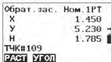
4. Визируйте первую известную точку и нажмите F1: [РАСТ], чтобы начать измерение. Если известных точек больше двух, отобразится F2: [УГЛЫ], можно подтвердить известную точку измерением угла.
