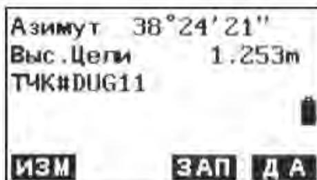
3. Нажмите F4: [ДА], чтобы принять введенные координаты точки стояния и задней точки, отобразится рассчитанный азимутальный угол.
