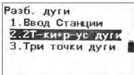
1. Нажмите F2: [МЕНЮ] на стр. 2 в режиме основных измерений и выберите «4. Разб. дуги (Разбивка дуги)», чтобы войти в меню разбивки дуги, выберите «1. Ввод Станции (Ориентация точки стояния)», чтобы установить точку стояния. Затем выберите «2. 2Т-ки+р-ус дуги», чтобы начать измерение с разбивкой 2-точечной дуги.
