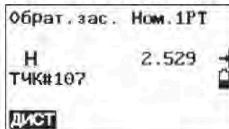
5. Визируйте первую известную точку и нажмите F1: [ДИСТ], чтобы начать измерение. Отображаются данные измерений.
