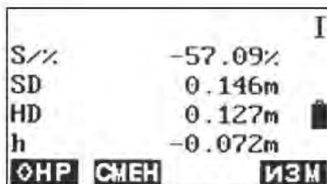
4. Наведите прибор на следующую точку P3 и нажмите F1: [ОНР], чтобы начать измерение. Повторите эти действия, чтобы измерить другие точки цели.
