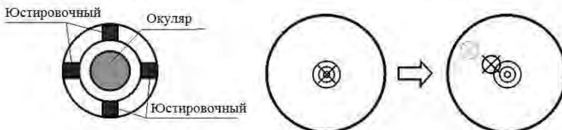
**ПРИМЕЧАНИЕ:** Для регулировки винтов прицела отвеса сначала ослабьте винт в направлении движения прицела, затем затяните другой винт на то же количество оборотов (чтобы затянуть винт, вращайте его по часовой стрелке, а чтобы ослабить винт — против часовой стрелки). Количество оборотов при затягивании и ослаблении винтов должно быть одинаковым.
