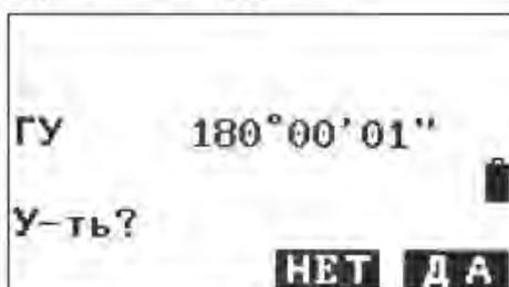
3. Сначала наведите прибор на прежнюю точку стояния, затем нажмите F4: [ДА], чтобы установить координаты прежней передней точки в качестве координат точки стояния, или нажмите F3: [НЕТ], чтобы сбросить.
