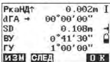
7. Отобразится разность измеренного значения и значения разбивки Рка НД. Двигайте призму вперед и назад, пока значение Рка НД не станет 0 м.
