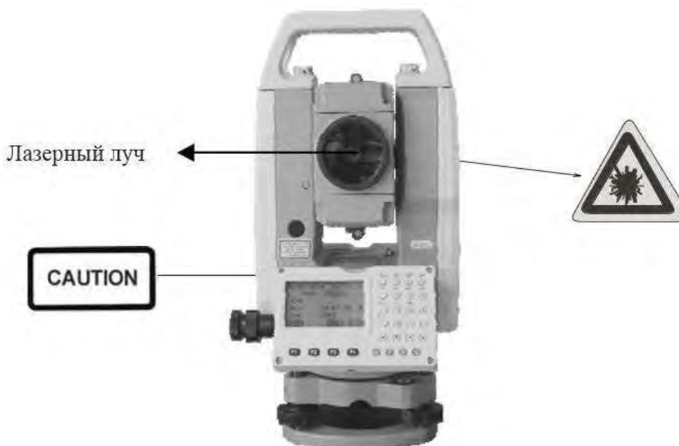
Рисунок 1 – Наклейка с оповещением об опасности лазерного излучения
