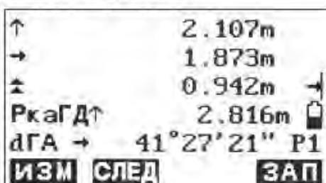
5. Нажмите F1: [ИЗМ], чтобы начать измерение координат с разбивкой. Передвигайте призму, чтобы найти точку разбивки.
