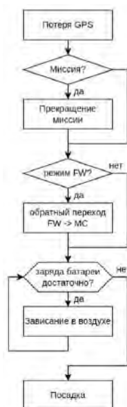
Figure 17: Блок-схема, описывающая поведение аппарата в случае потери сигнала gps
