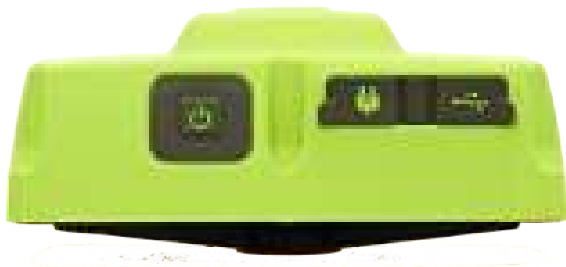
Рисунок 4. Кнопка вкл/выкл, разъемы питания и USB
