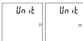
Долго нажмайте на кнопку измерения **2**. Когда курсор встанет на нужную настройку, отпустите кнопку измерения **2**. После отпускания измерительный инструмент включается с выбранной настройкой.
