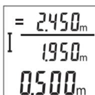
Чтобы включить лазерный луч, коротко нажмите на кнопку измерения **2**. Чтобы произвести еще одно измерение, еще раз коротко нажмите на кнопку измерения **2**. В нижней строке отображается актуальное измеренное значение **c**. В средней строке отображается предыдущее измеренное значение **b**. В верхней строке отображается автоматическая сумма **a** (сумма актуального и предыдущего измеренного значения).
