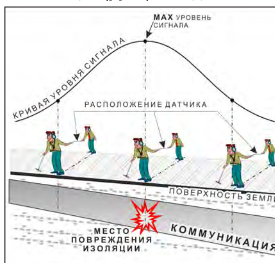
применение датчика-определителя дефектов коммуникации (ДОДК) методом max
