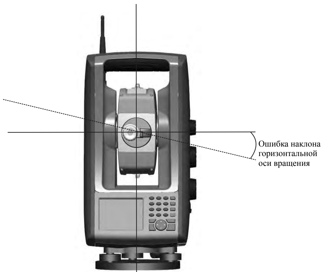
Рисунок 6.1 Ошибка наклона горизонтальной оси вращения
