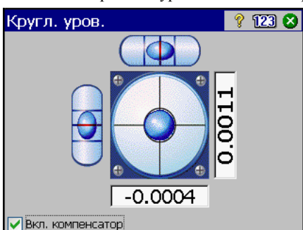
Рисунок 4.6 Электронный уровень для нивелировки
