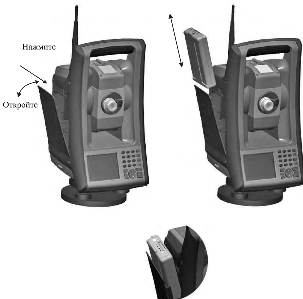
Рисунок 3.3 Извлечение и установка внутренней батареи
