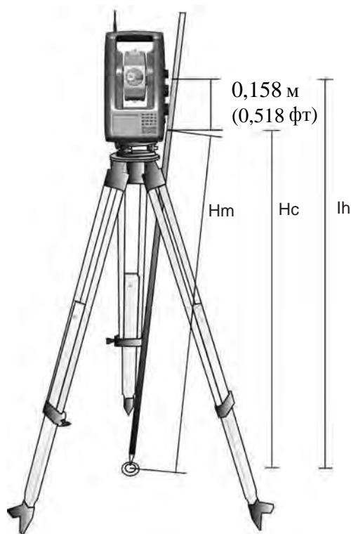
Рисунок 4.53 Измерение высоты инструмента
