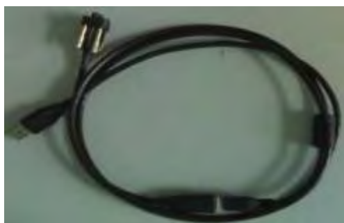
Рисунок 5 – USB –кабель для соединения ручного контролера «Psion» и компьютера
