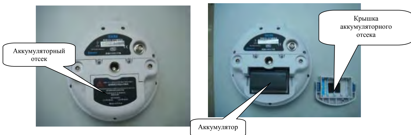
Рисунок 2.4 – Установка аккумулятора в S82-T
