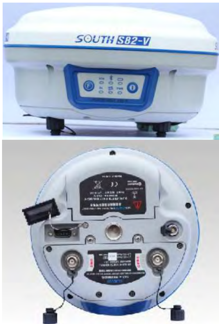
Рисунок 2.1.2 Общий вид и компоновка составляющих S82-V
