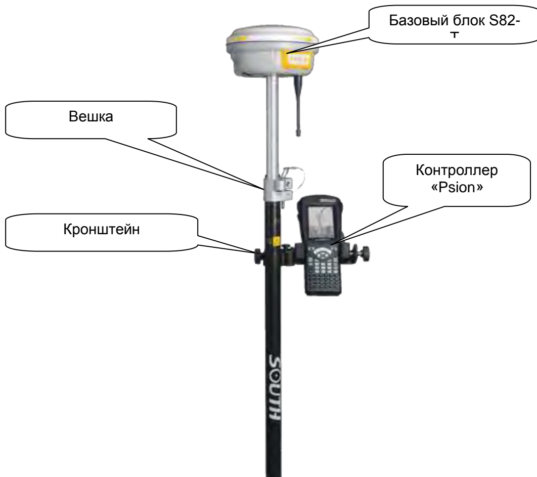
Рисунок 4.2 – Установка роверного комплекта S82-Т
