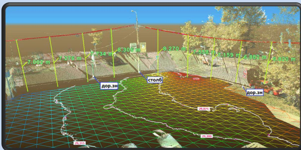
Важное преимущество **Cyclone MODEL** – инструменты трехмерного моделирования, с помощью которых программа в автоматическом режиме встраивает геометрические элементы в облака точек. Контроль качества встраивания дает пользователю возможность оценивать точность моделирования. Кроме того, существует возможность загружать библиотеки стандартов и использовать их при моделировании трубопроводов и металлоконструкций.
