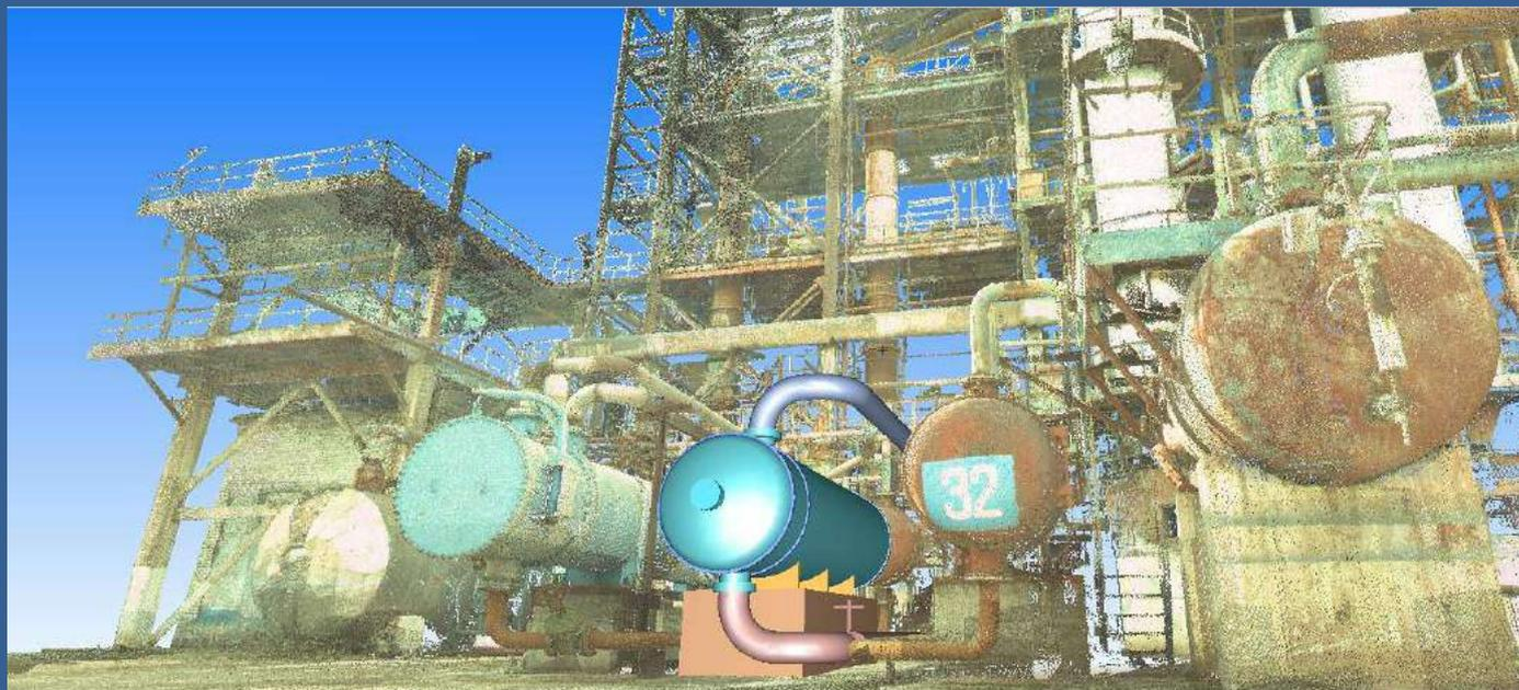
**Cyclone MODEL** – программа, которая стала эталоном в области моделирования по облакам точек. Она включает в себя все функции модуля Cyclone SURVEY, необходимые для создания планов и чертежей, а также содержит инструменты по трехмерному моделированию промышленных и гражданских объектов. Полученные данные экспортируются в традиционные САПР и используются для решения задач реконструкции производств, при геодезических изысканиях, в архитектуре и строительстве.
