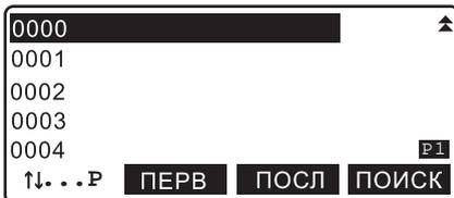
Выводится экран <Данные для выноса>. На экране отображаются имя исходной точки и ее высотная отметка.
