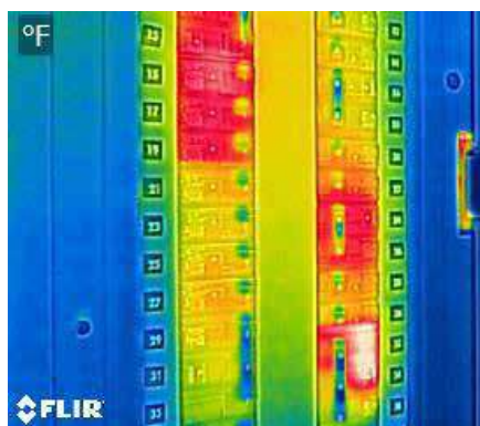
Распределительный щит E8 с функцией MSX
