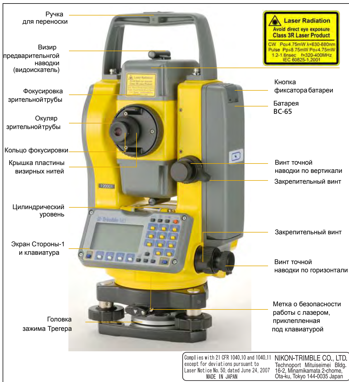
Рисунок 2.2 Электронный тахеометр Trimble M3 – Сторона-1 (управляющая сторона)
