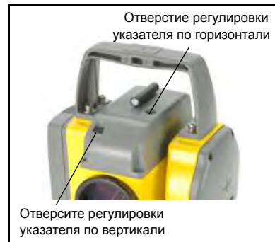
Юстировочные отверстия лазерного указателя
