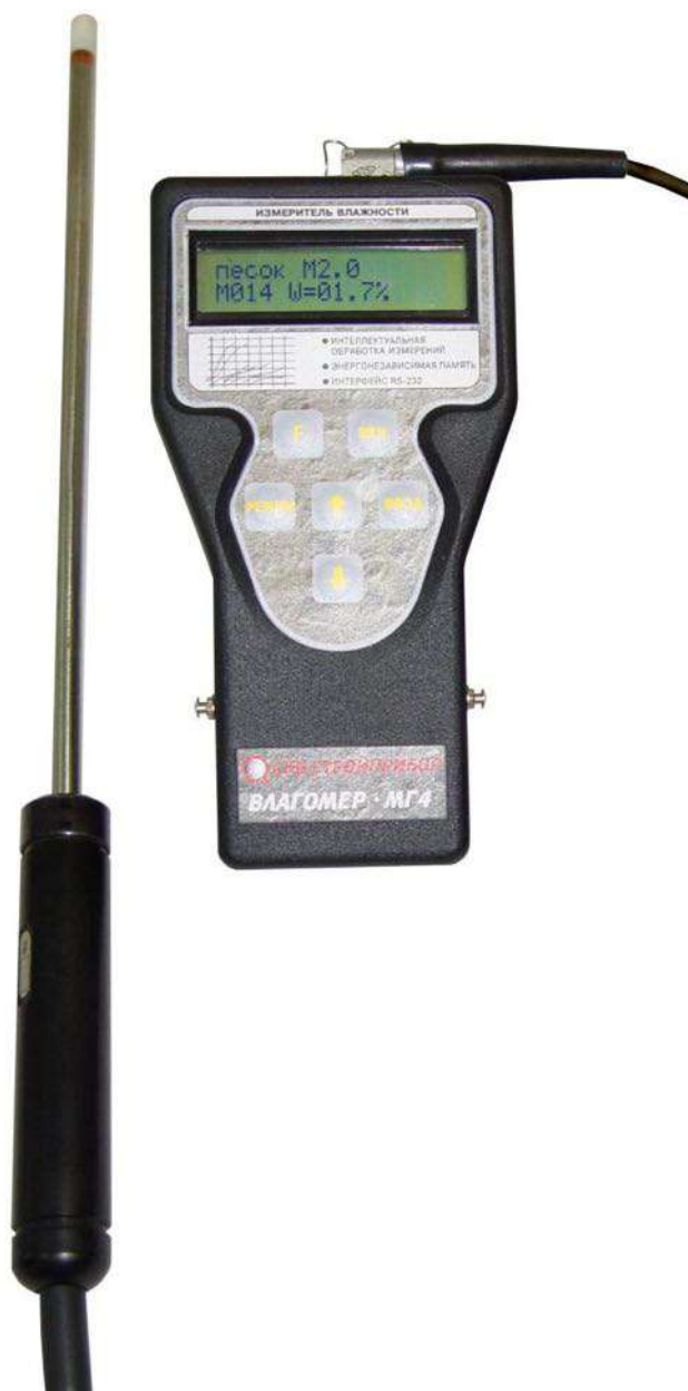
Рисунок 1 – Общий вид измерителя влажности электронного Влагомер-МГ4-3
