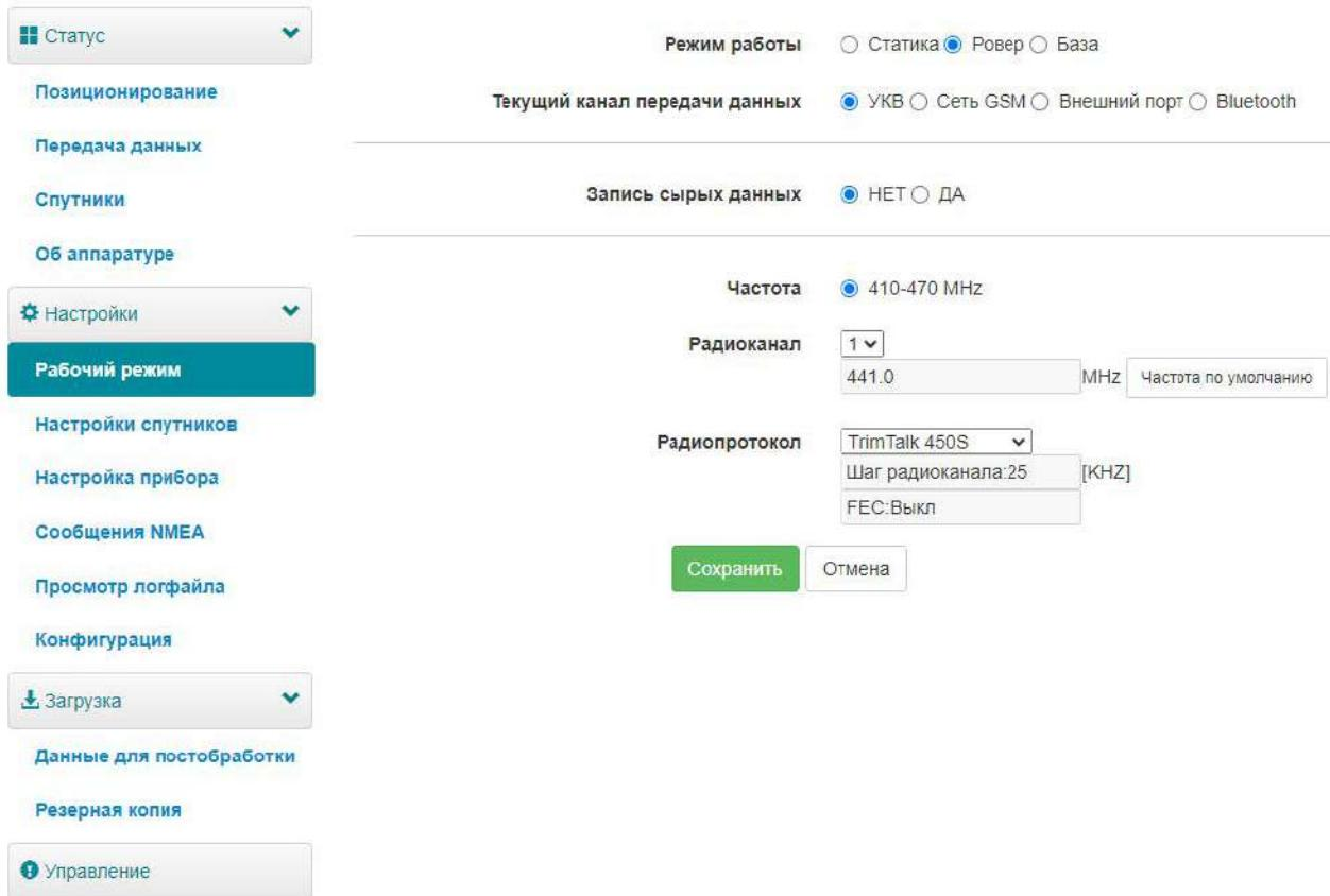
The screenshot shows the 'Working mode' configuration page. On the left, there's a sidebar with tabs: Статус (Status), Позиционирование (Positioning), Передача данных (Data transmission), Спутники (Satellites), Об аппаратуре (About hardware), Настройки (Settings) (selected), and Рабочий режим (Working mode) (highlighted in teal). Below these are sections for загрузка (Upload) and управление (Management).
