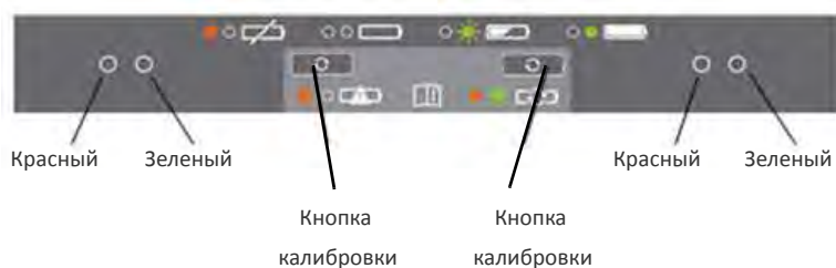
Рисунок 3.5 Панель управления зарядного устройства с двумя отсеками
