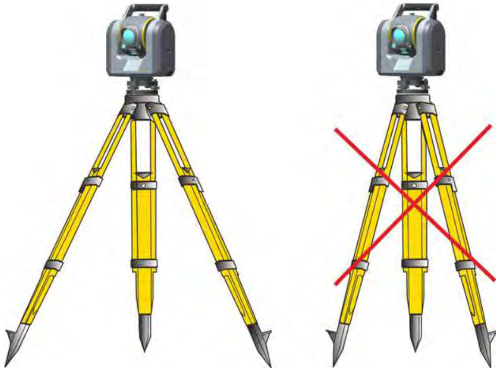
Рисунок 4.1 Правила установки инструмента
