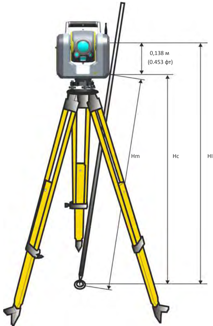
Рисунок 4.4 Измерение высоты инструмента
