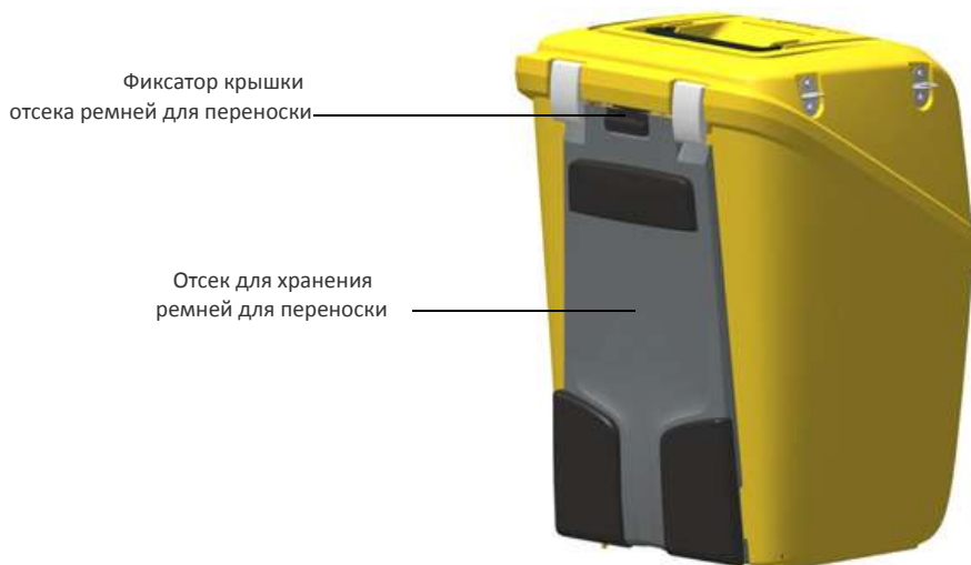
Рисунок 2.3 Футляр инструмента с ремнями для переноски в специальном отсеке
