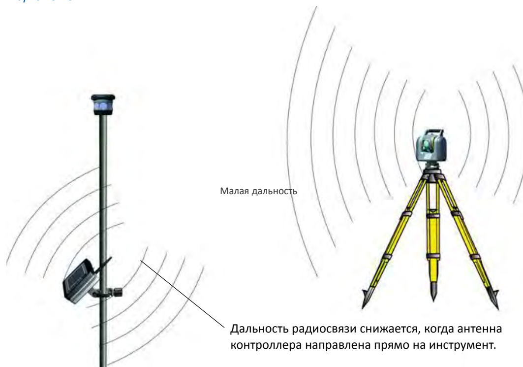
Рисунок 5.12 Снижение дальности радиосвязи, если антенна контроллера находится не в вертикальном положении, как антенна инструмента
