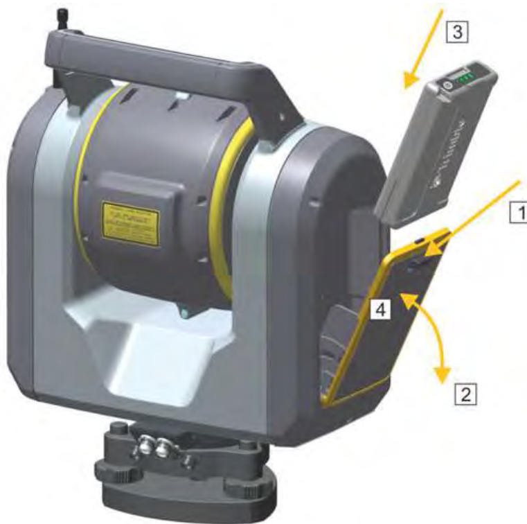
Рисунок 4.5 Как установить и/или извлечь внутренний аккумулятор
