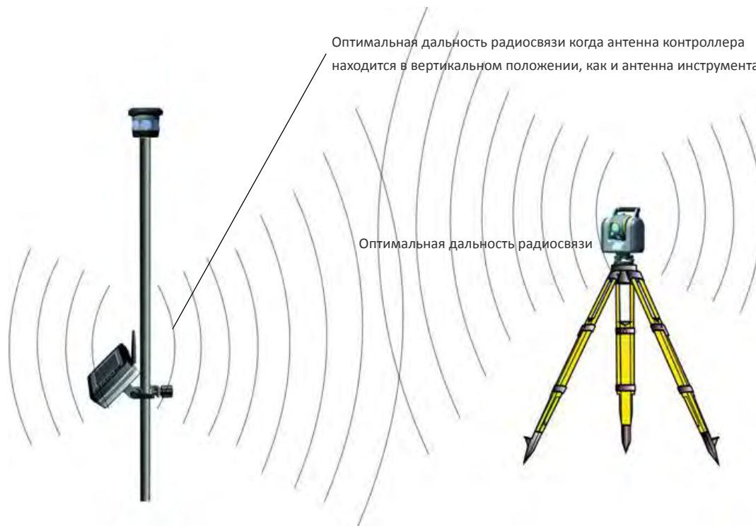
Рисунок 5.13 Оптимальная дальность радиосвязи, если антенна контроллера находится в вертикальном положении, как и антенна инструмента
