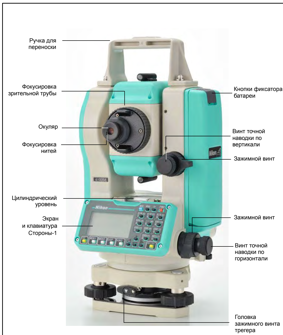
Рисунок 1.1 Электронный тахеометр DTM-322 – Сторона-1
