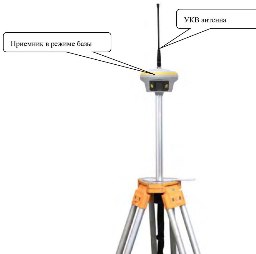
Приемник в режиме базовой станции с антенной УКВ
