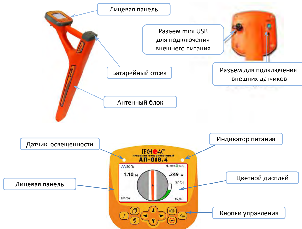
Рисунок 1. Внешний вид и лицевая панель с кнопками управления.
