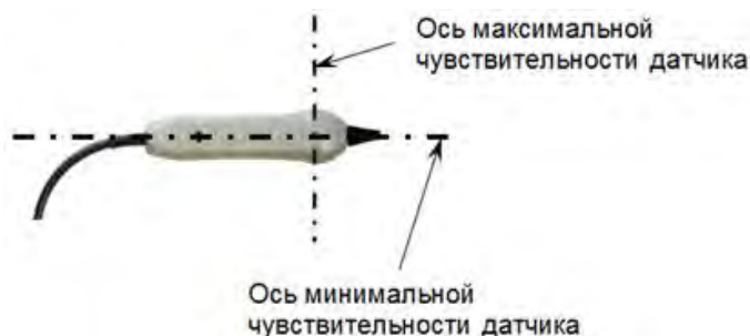
Рисунок А.2 Оси чувствительности датчика ЭМД-127.
