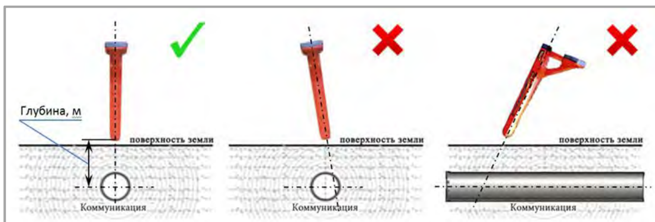
Рисунок 6. Положение приемника при замере глубины.
