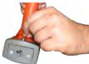
а) Выдвинуть фиксатор, освободить батарейный отсек
