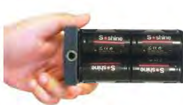
б) Вставить батареи в отсек, соблюдая полярность
