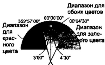
→ Разность углов, измеренных на шаге 7 и 8 составляет  $1'30''$ , при этом разделительная линия зеленого и красного цвета указателя створа смещена вправо (в зеленую зону).
