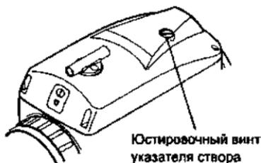
11. Снова повторите действия 7 - 9. Если измеренная разность углов превышает  $1'$ , повторите юстировку, как описано на шаге 10. Если измеренная разность углов не превышает  $1'$ , юстировка завершена.
