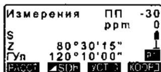
В случае если снова выводится сообщение "Вне диапазона" или экран компенсатора углов наклона, повторно приведите инструмент к горизонту.
