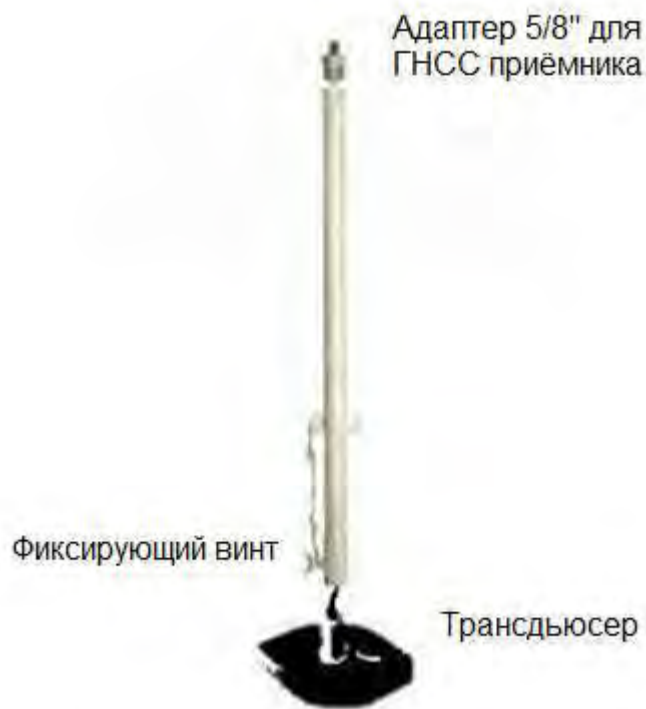
Рис. 2.4 Монтаж оборудования на вехе
