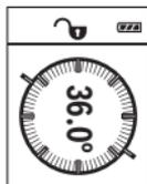
Режим измерения наклона служит для измерения подъема или уклона (напр., лестничных пролетов, лестничных площадок, при подгонке мебели, при прокладке труб и т.д.).
