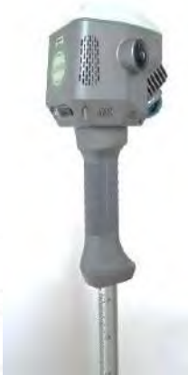
Прибор на ручке-батарее и на веже (для длительного сканирования)
