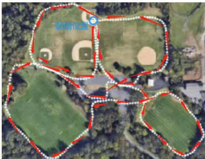
Схема блочного сканирования больших пространств
