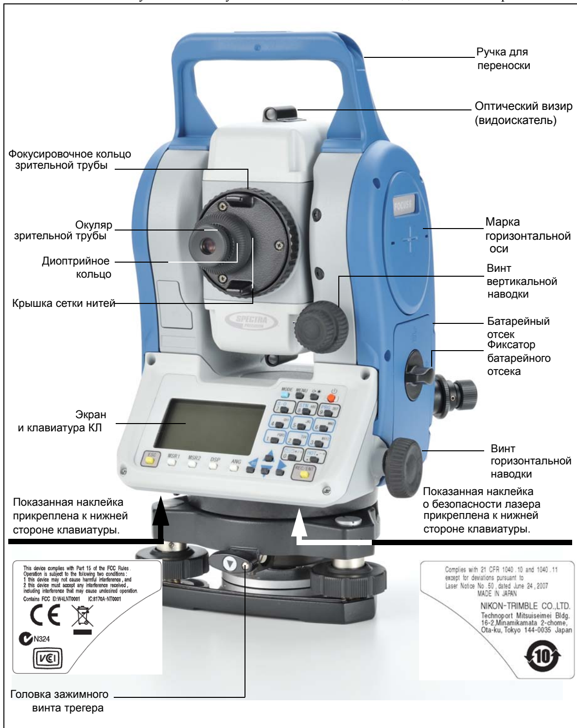
Рисунок 3.1 Тахеометр Focus 6 5", вид сзади (КЛ)
