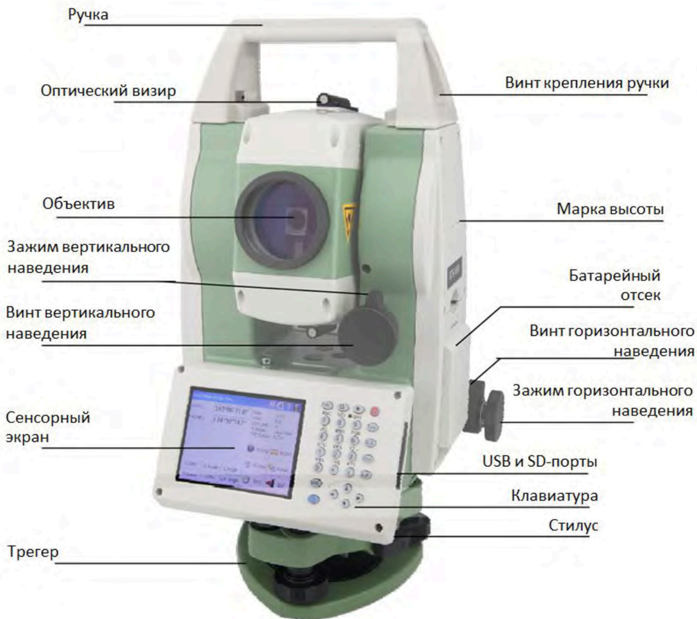
Рисунок 3 - Основные элементы тахеометра RTS010
