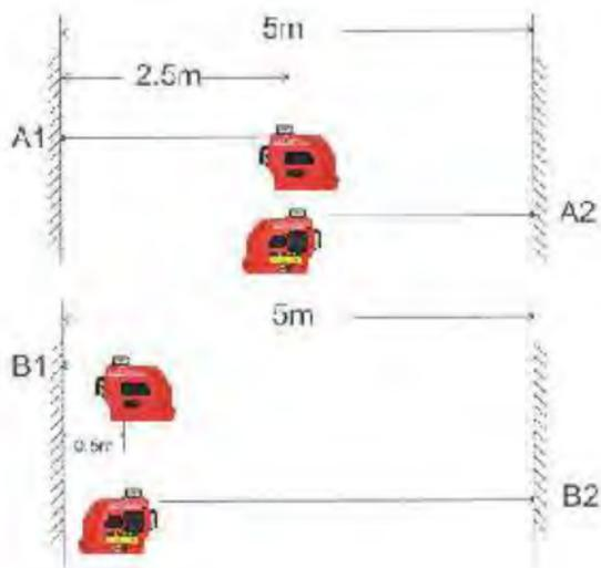
Проверка вертикальной точности.
