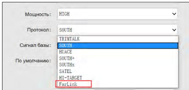
Для связи ровера с базовой станцией настройки **Скорость по эфиру**, **Канал**, **Протокол** должны быть одинаковы, иначе они не смогут подключиться друг к другу.
