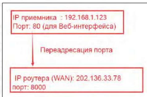
После настройки переадресации портов компьютер или мобильный телефон может получить доступ к Веб-интерфейсу приемника, как показано на изображении ниже.
