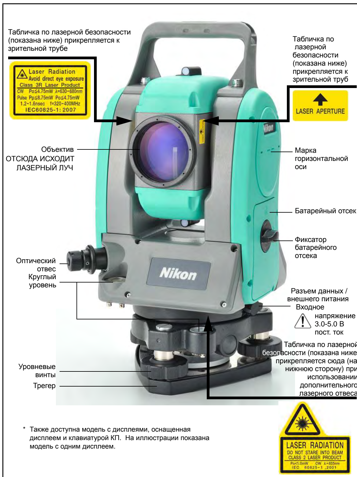
Рисунок 1.2 Электронный безотражательный тахеометр серии Nivo – Сторона-2
