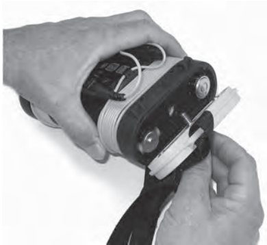
Рис. 3: Снятие крышки с отсека батарей
