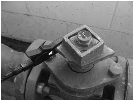
Рис. 7: Соединение прибора ST-305 с магистралью
