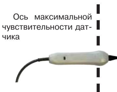
Выбор кабеля по максимальному сигналу
