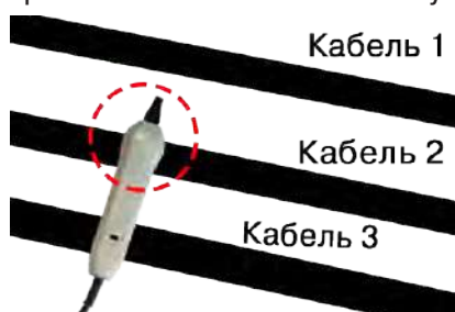
Выбор кабеля по максимальному сигналу
