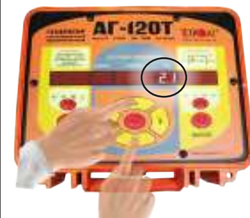
8. Установить трассировочный «ток» в коммуникации
