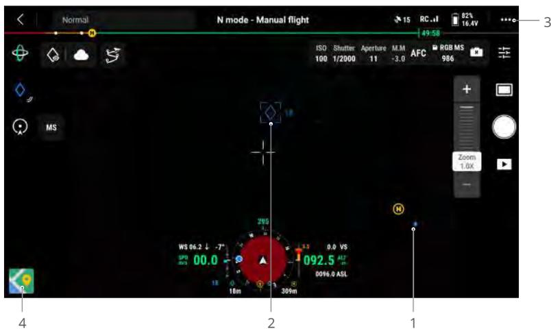
1. В виде с камеры для отметки точек будет создана проекция дополненной реальности. Размер отметки точек будет отрегулирован в зависимости от расстояния между дроном и отметкой точек (больше, если она ближе, и меньше, если дальше).
