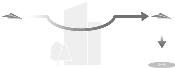
2. **Оптимальные:** вне зависимости от параметров высоты RTH дрон автоматически планирует оптимальный путь возврата домой и меняет высоту в соответствии с такими факторами окружающей среды, как препятствия и сигналы передачи. Оптимальный путь возврата домой означает, что дрон пройдет наикратчайшее возможное расстояние при снижении используемой мощности аккумулятора и увеличении времени полета.
