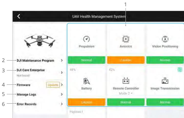
1. Диагностика ошибок: для проверки текущего состояния каждого модуля дрона. Пользователи могут решать проблемы, следуя соответствующим инструкциям.
