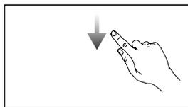
Проведите по экрану сверху вниз, чтобы открыть индикатор состояния в приложении DJI Pilot 2. Индикатор состояния отображает такую информацию, как время, сигнал Wi-Fi и уровень заряда аккумулятора пульта управления.
