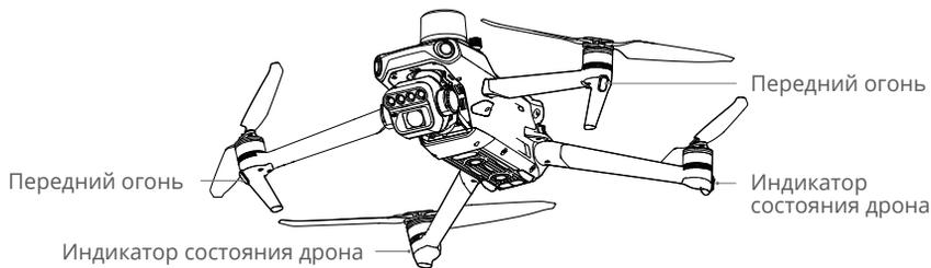
Если дрон включен, а моторы не работают, передние огни загорятся красным светом для отображения ориентации аппарата.
