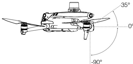
Управлять наклоном камеры можно при помощи колесика камеры на пульте управления. Кроме того, вы можете перейти в вид с камеры в DJI Pilot 2. Нажимайте на экран до появления круга и перетяните его вверх или вниз для изменения наклона камеры.
