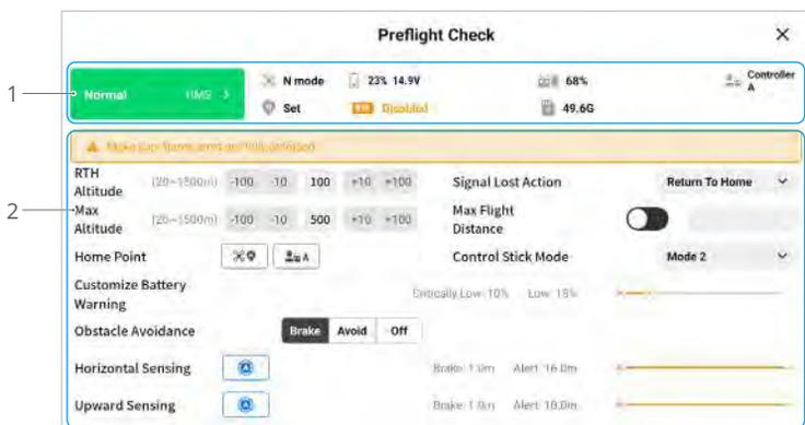
1. Просмотрите информацию о работоспособности дрона, режиме полета, уровне заряда аккумулятора Intelligent Flight Battery, уровня заряда аккумулятора пульта управления, состоянии домашней точки, состоянии RTK и информацию о карте памяти microSD камеры.
