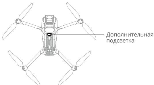
⚠ При слабом освещении системы обзора не всегда могут достичь оптимальной эффективности позиционирования даже с включенной дополнительной нижней подсветкой. Будьте осторожны в полете при полете в таких условиях со слабым сигналом GNSS.
