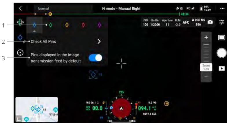
1. Нажмите и удерживайте значок отметки точек на сенсорном экране, чтобы открыть панель настроек отметки точек. Для отметки точек существует пять вариантов цветов, и пользователям рекомендуется задавать отдельный цвет для каждого типа отметки в зависимости от сценария эксплуатации.
