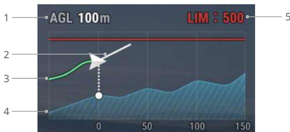
1. Высота над уровнем земли (AGL): высота дрона относительно поверхности земли под ним.
