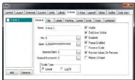
Если автоматический "скролл" оси X не требуется, снимите галочку на вкладке X-Axes > Tracking > "Enable".
