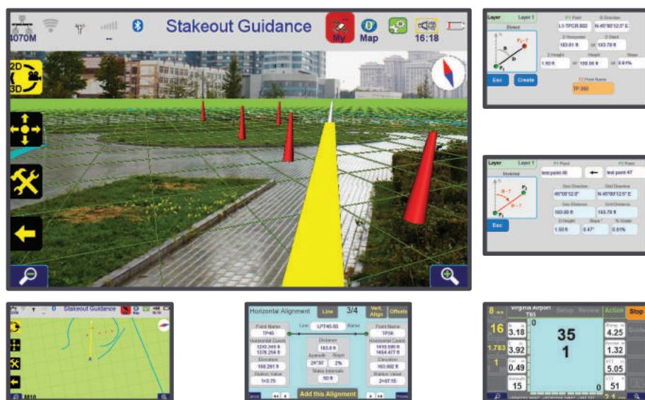
При использовании технологии визуального выноса виртуальные точки для выноса обозначаются флагжками на экране приемника, отображающем реальное изображение с фронтальной или нижней встроенных фотокамер. Такое наглядное обозначение точек на местности позволяет сделать процесс выноса легким и быстрым. Во время визуального выноса на экране все время будет отображаться получаемое с фотокамеры изображение в режиме реального времени.
