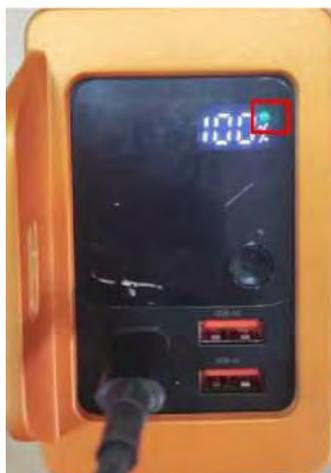
Рисунок 2-3 индикатор включения аккумулятора GLS10
