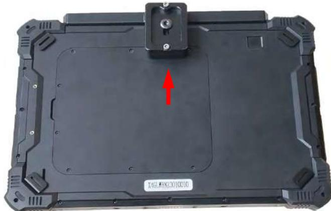
Рис. 8 Выдвижная заглушка на задней панели планшета
