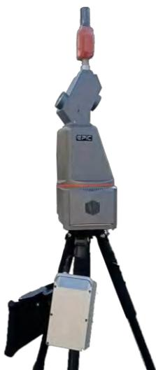
Рис. 20 Подключение камеры и RTK
