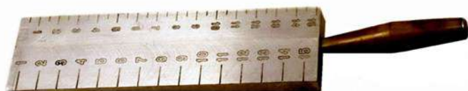
Рисунок 5 – Общий вид клинового промерника
