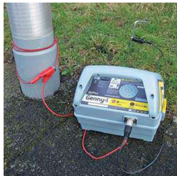
Способ трассировки кабелей малого диаметра
