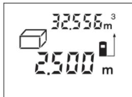
По окончании третьего измерения объем автоматически рассчитывается и высвечивается на дисплее. Последнее единичное измерение высвечивается на дисплее внизу, а конечный результат – вверху.
