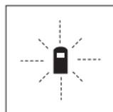
Измерительный инструмент проверяет правильность работы при каждом измерении. При констатации неисправности на дисплее мигает только показанный рядом символ. В таком случае, а также если названные выше меры не привели к успеху, отдайте измерительный инструмент через магазин в сервисную мастерскую фирмы Bosch.
