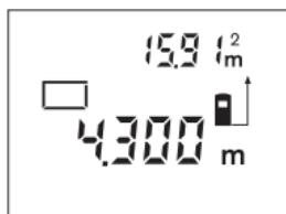
По окончании второго измерения площадь автоматически рассчитывается и высвечивается на дисплее. Последнее единичное измеренное значение высвечивается на дисплее внизу, а конечный результат – вверху.
