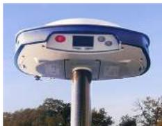
Spectra Precision SP80 представляет собой приемник GNSS нового поколения, сочетающий десятилетний опыт технологии RTK GNSS с революционно новым процессом обработки данных GNSS. С новым 240-канальным чипсетом 6G система SP80 оптимизирована для отслеживания и обработки сигналов от всех созвездий GNSS.
