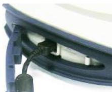
Приемник оснащен разъемом USB, который вы можете использовать для установления эмулированной последовательной линии связи RS232 с компьютером. Это соединение доступно только для устранения неполадок.
