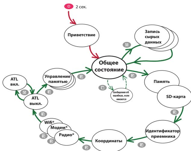
\*: Пропускается (не показано), если устройство отсутствует (только радио) или выключено
