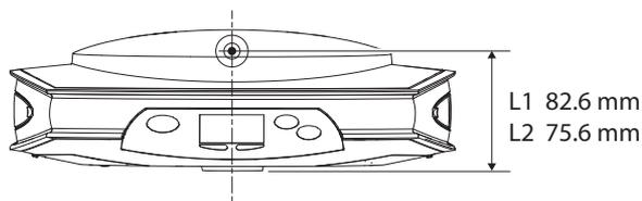
Учтите, что приемник автоматически применит эту дельту после установки модуля УВЧ, присвоив SP80другое имя. Фактически существуют два отдельных имени антенны для &#x2013;. Одно описывает параметры антенны, когда модуль УВЧ не используется (имя антенны с суффиксом «-1»), другое – когда используется модуль УВЧ (суффикс «-2»).
