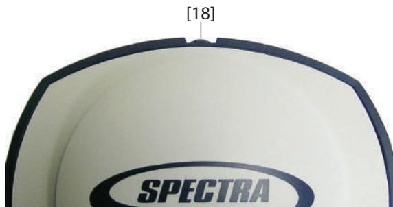
Когда приемник установлен на штативе – например, для использования в качестве базы – выполнить наклонное измерение зачастую более удобно, чем вертикальное измерение от наземной отметки до базы антенны.
