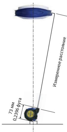
Когда вы получите от полевого программного обеспечения запрос на ввод данных для определения высоты инструмента, вы выберете ввод наклонного измерения, а не вертикального измерения. После этого программное обеспечение сможет вывести реальную высоту инструмента из известных размерных параметров антенны и введенного вами наклонного измерения.
