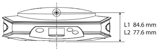
Полевое программное обеспечение обычно рассчитывает реальную высоту инструмента, основываясь на местонахождении фазового центра L1.
