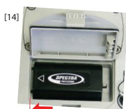
5. Закройте крышку: Рекомендуется тщательно закрыть крышку двумя большими пальцами, нажав на оба уголка крышки. Так вы плотно защелкнете крышку и обеспечите полную водонепроницаемость батарейного отсека.
