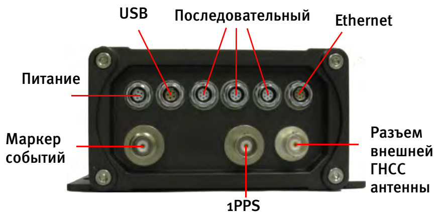
Рисунок 3. Передняя панель приемника SIGMA
